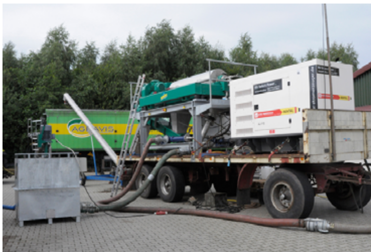
Die RWG Emsland-Süd separiert mit dieser mobilen Zentrifuge Gülle, um überschüssiges Phosphat kostengünstig aus den Betrieben zu schaffen.
