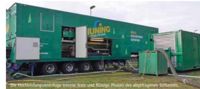
Die Hochleistungszentrifuge trennte feste und flüssige Phasen des abgetragenen Schlammes.
